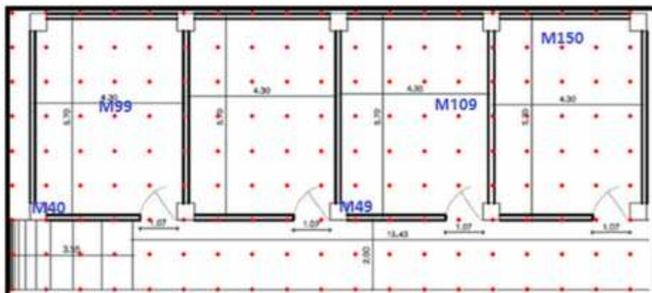
Figura 10-3. Ubicación de los puntos usados para las pruebas de error de distancia WIFI
