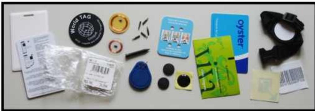
**Figura 17-1.** Modelos de tags RFID.
