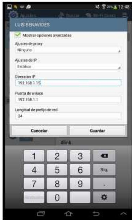
**Figura 4-3.** Configuración de la dirección IP del dispositivo móvil
