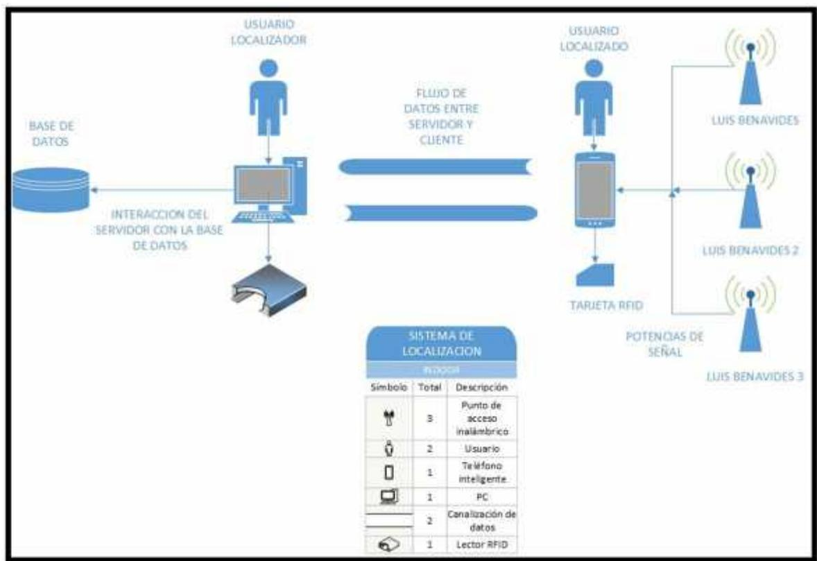
**Figura 4-2.** Topología del sistema de localización WIFI-RFID
