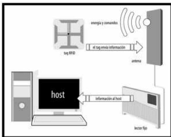
**Figura 14-1.** Comunicación entre tag, lector y host.
