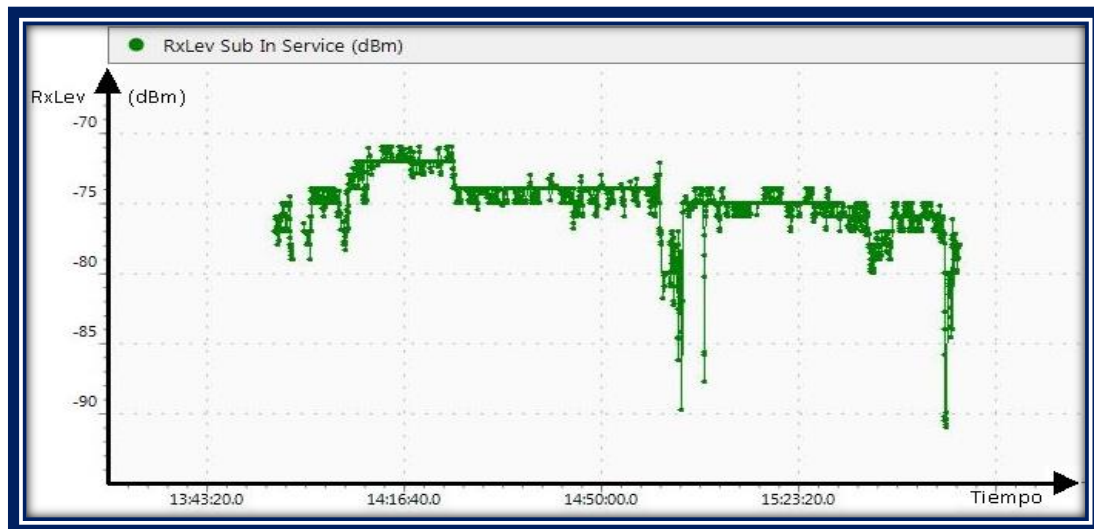
FIGURA 3-24 Nivel de potencia de la señal GSM de la operadora Movistar
