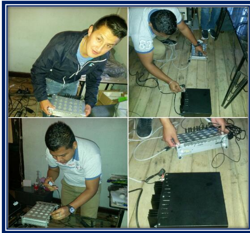
FIGURA 2-1 Instalación de una RTU fijo
