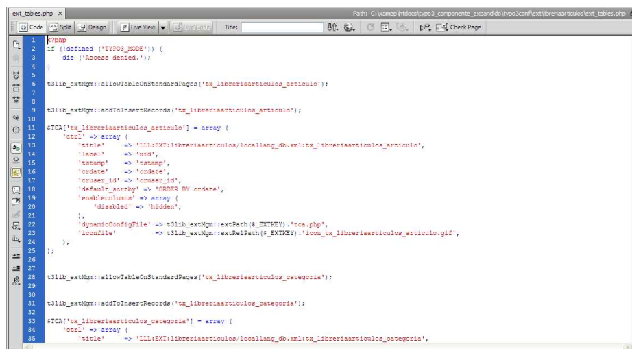
Figura III. 83: Código necesario para el ingreso de datos de un artículo en la base de datos en el archivo ext_tables.php - Módulo 3 Herramienta Typo3
