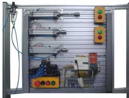
Figura IV. 28 Salida del Cilindro A+ en el tablero de aluminio
