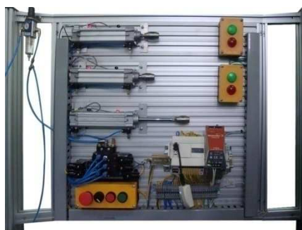
Figura IV. 44 Salida del Cilindro C + en el tablero de aluminio
