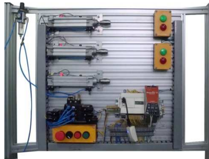
Figura IV. 46 Retorno del Cilindro C - en el tablero de aluminio
