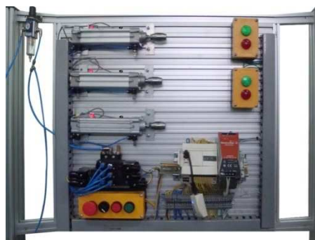
Figura IV. 26 Elementos inactivos del control neumático inalámbrico didáctico
