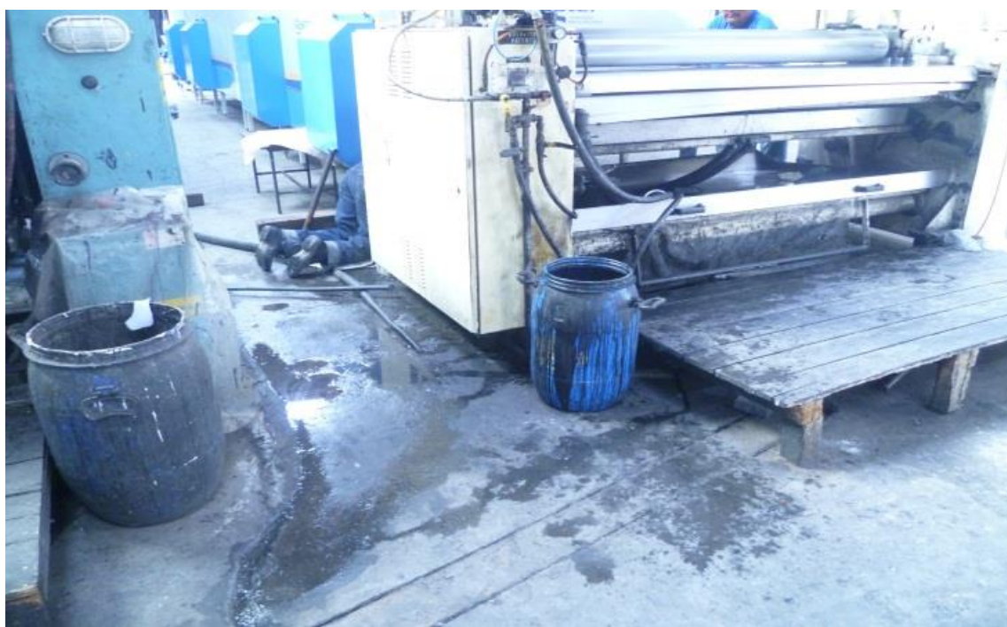
Fotografía 10. Falta de control en fugas de aceite y demás desechos de la maquinaria.
