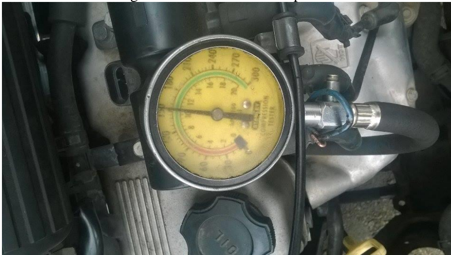
Figura 33. Medición de compresión
