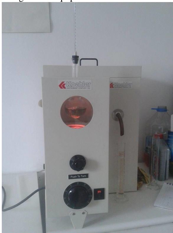
Figura 18. Equipo de destilación Koehler
