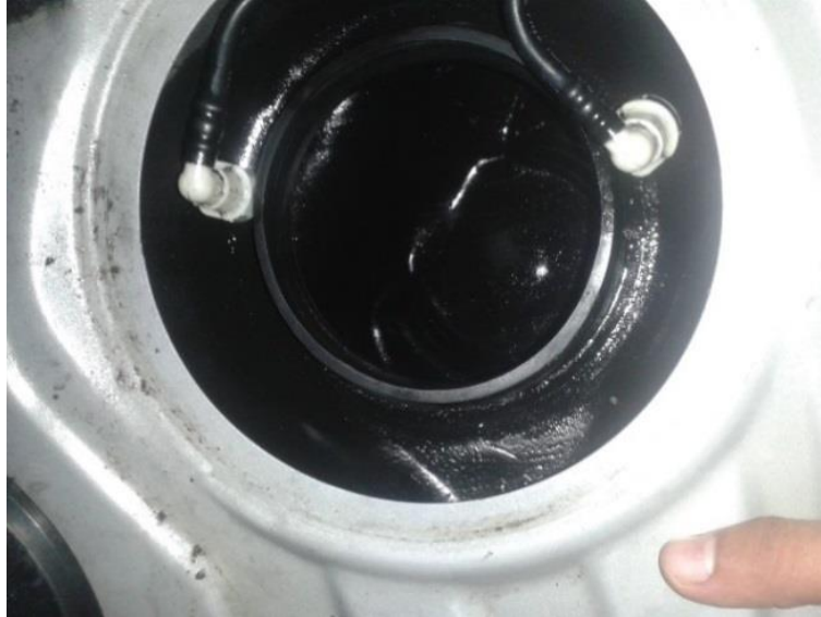
Figura 30. Limpieza del tanque del combustible.
