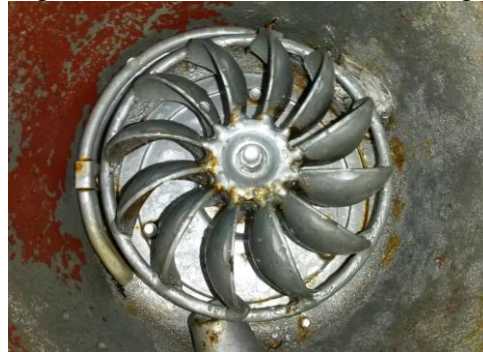
Figura 71. Alabes de la turbina Turgo
