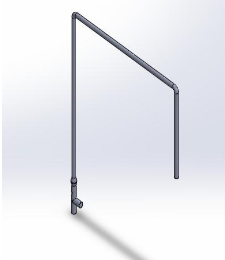
Figura 58. Tubería para medir el caudal
