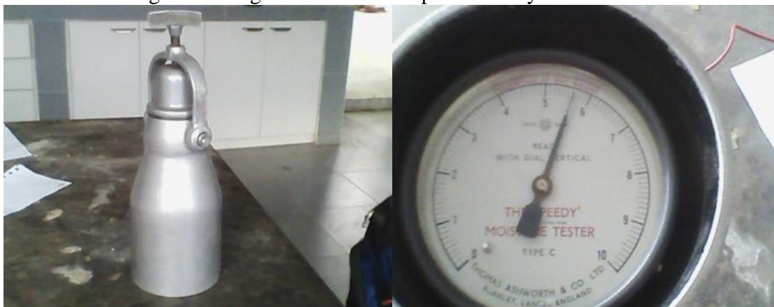
Figura 29. Higrómetro utilizado para el ensayo de humedad.
