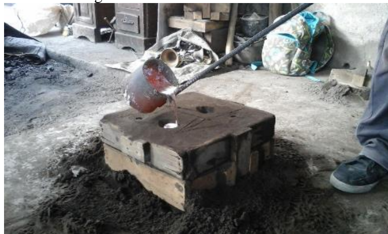
Figura 45. Colado de metal fundido.
