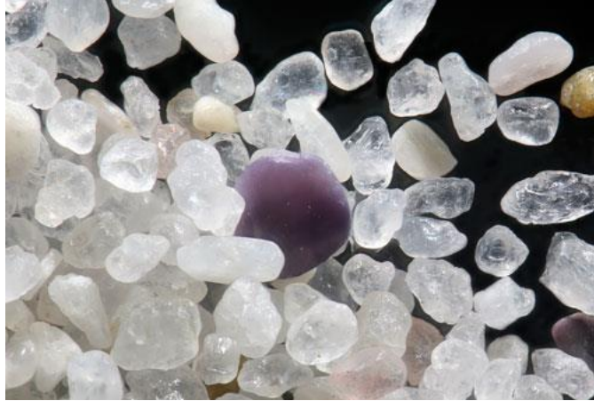
Figura 26. Arena vista desde el microscopio a 25x.
