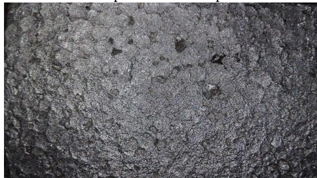
Figura 49. Porosidades en la pieza fundida a partir de molde poliestireno.
