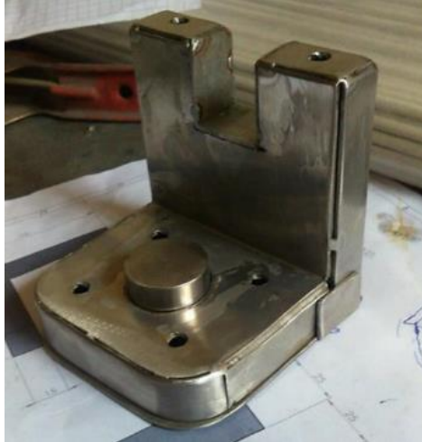
Figura 10. Matriz para la expansión de poliuretano.
