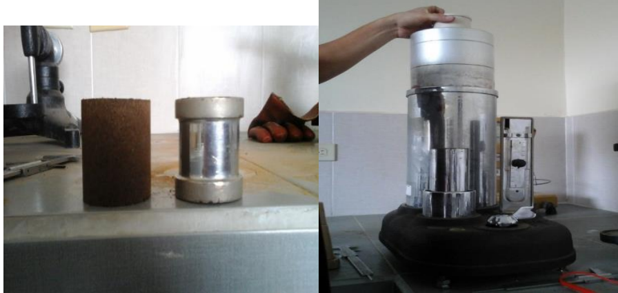
Figura 30. Máquina para ensayo de permeabilidad
