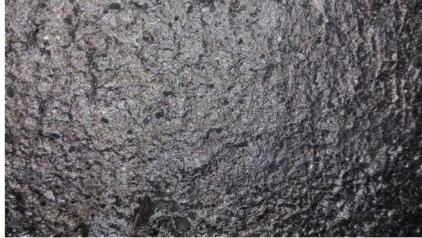
Figura 50. Pequeñas puntas de alfiler en la pieza fundida.
