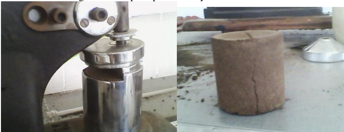
Figura 32. Máquina para el ensayo de corte en arenas.
