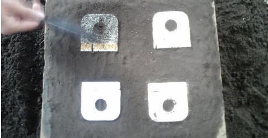
Figura 44. Modelos de poliuretano y poliestireno dentro del molde de arena.
