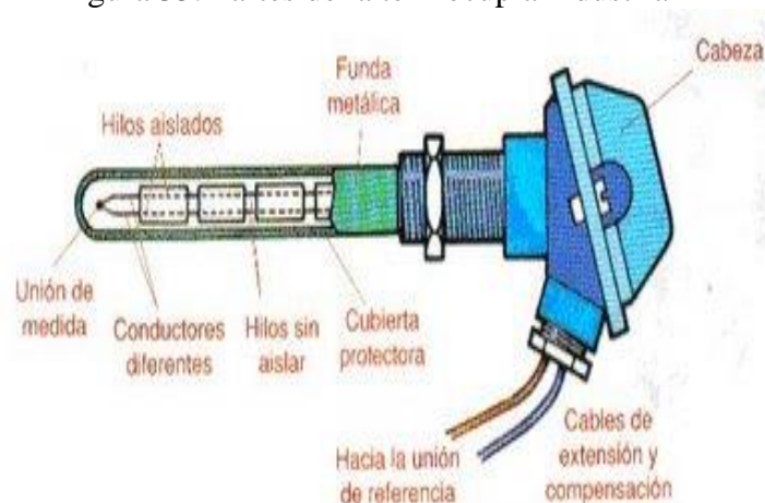
Figura 35. Partes de la termocupla industrial
