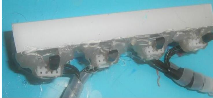
Figura 68. Sensores de humedad
