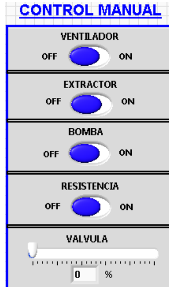
Figura 82. Control manual de actuadores
