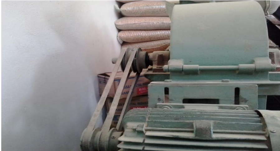
Figura 23 - 4. Molino de granos, Riesgo Mecánico de atrapamiento por o entre objetos Fuente: FERNANDEZ,Sandra, 2016
