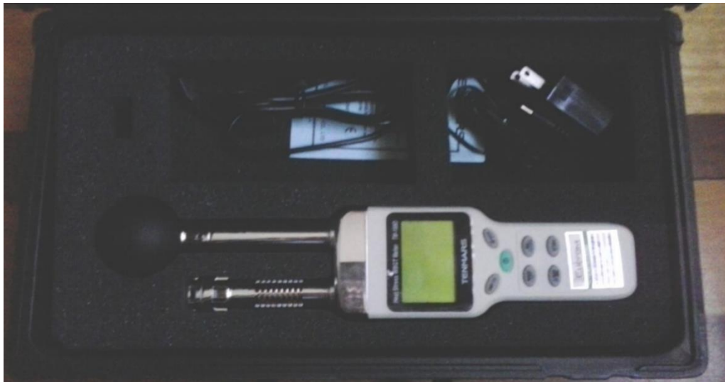
Figura 30 - 4. Medidor de Estrés Térmico
