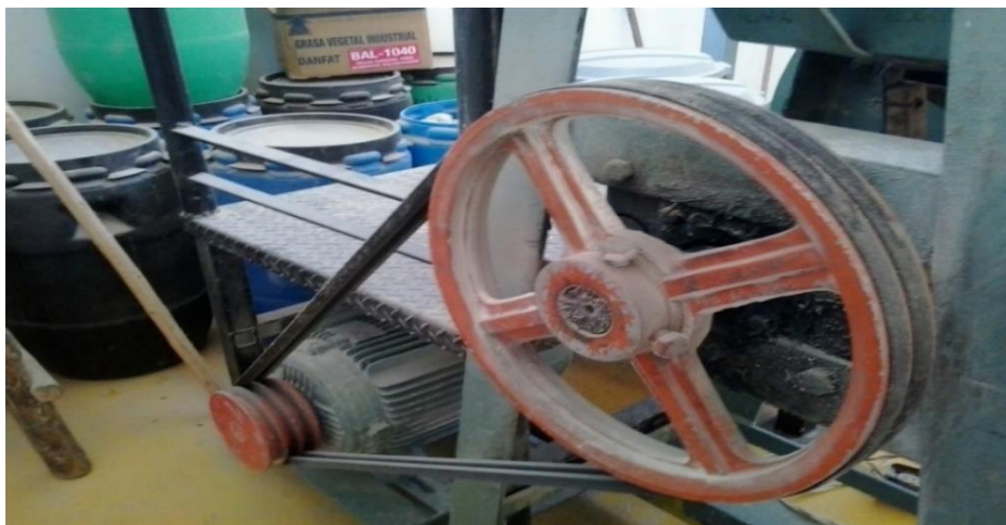
Figura 22 - 4. Molino de martillo, Riesgo Mecánico de atrapamiento por o entre objetos
