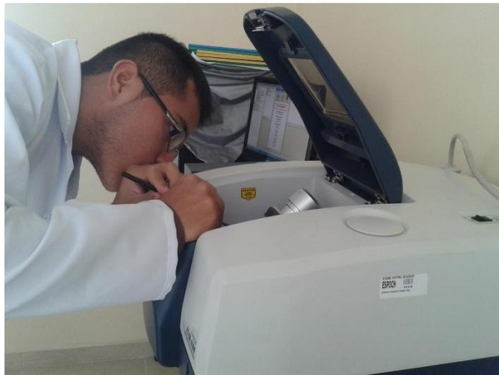
**Fotografía 6** Prueba de producción de PHA utilizando Infrarrojo por Transformada de Fourier
