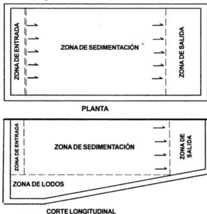
Figura 2. Zonas de un desarenador
