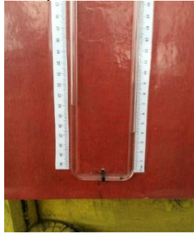
Figura 68. Lectura de presión diferencial en el medidor 2
