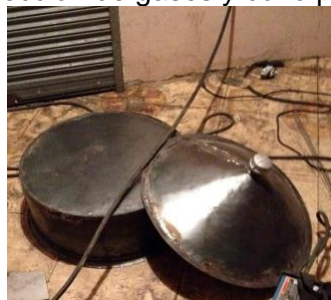
Figura 52. Cámara de recolección de gases y cono para depósito de sedimentos.
