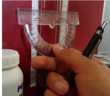
Figura 71. Medición de la presión diferencial en el tubo en U.
