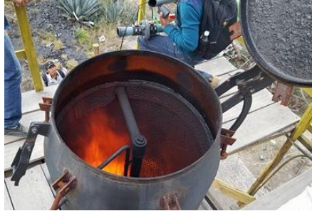
Figura 62. Calentamiento del gasificador
