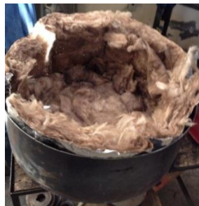
Figura 51. Cilindro exterior de la cámara de recolección de gases aislado térmicamente.
