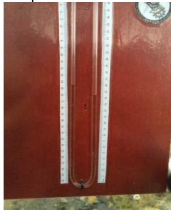
Figura 67. Lectura de presión diferencial en el medidor 1 PVC
