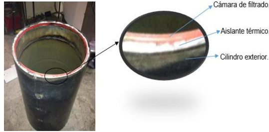
Figura 49. Cámara de filtrado aislada con cilindro exterior.
