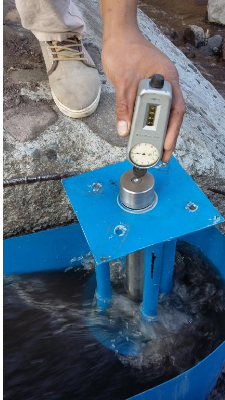
Figura 40. Medición del número de revoluciones en el eje en vacío
