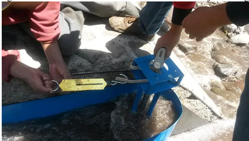
Figura 41. Medición del número de revoluciones en el eje con carga
