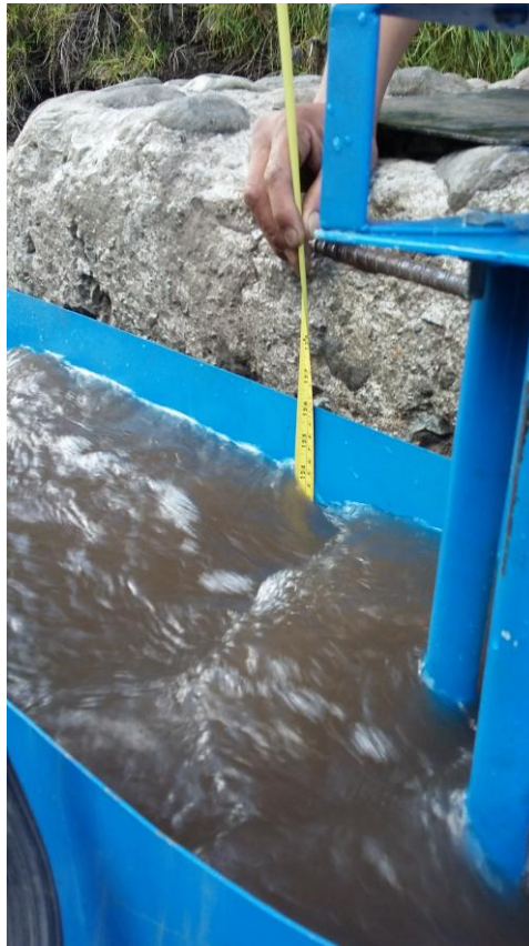
Figura 39. Medición del nivel de fluido en el canal
