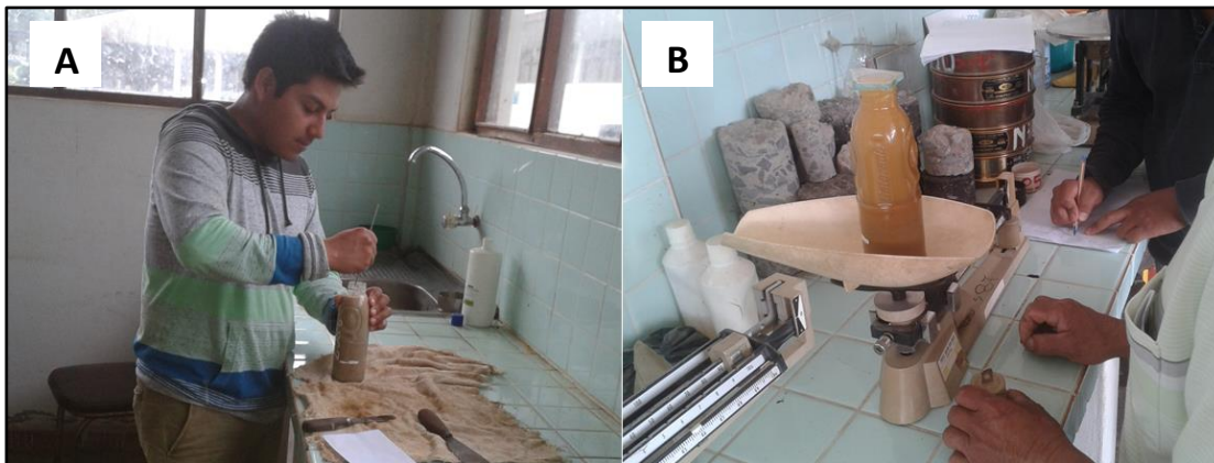
Fotografía 17-3: Ensayo de picnómetro. A) Eliminación de los vacíos de la muestra. B) Pesado de la muestra saturada
