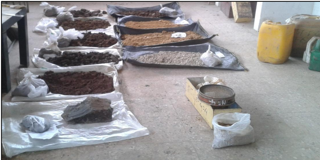
Fotografía 13-3: Preparación de la muestra y ensayo granulométrico Elaborado por: Jaramillo, J. y Pasato, J. (2015)
