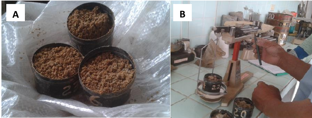
Fotografía 15-3: Ensayo de humedad del suelo. A) Muestras húmedas. B) Pesado de las muestras Elaborado por: Jaramillo, J. y Pasato, J. (2015)
