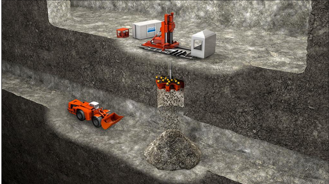
Grafico 12. Proceso de escariado en niveles subterráneos
