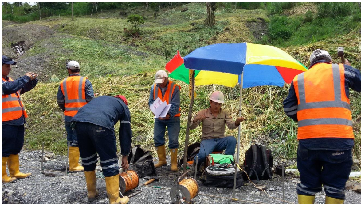
Fotografía 15: Instalación del resistímetro para realizar el primer SEV.
