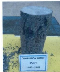
MUESTRA LUEGO DE ENSAYO
