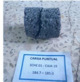
MUESTRA LUEGO DEL ENSAYO
