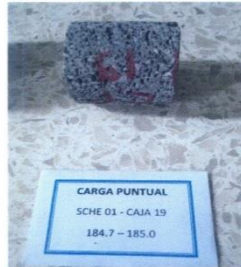
MUESTRA ANTES DEL ENSAYO
