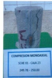
MUESTRA LUEGO DEL ENSAYO
