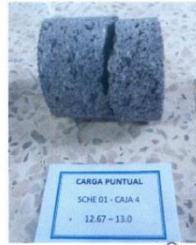
MUESTRA LUEGO DEL ENSAYO
