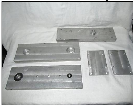
Figura 53. Partes mecanizadas en aluminio que conforman el hombro
