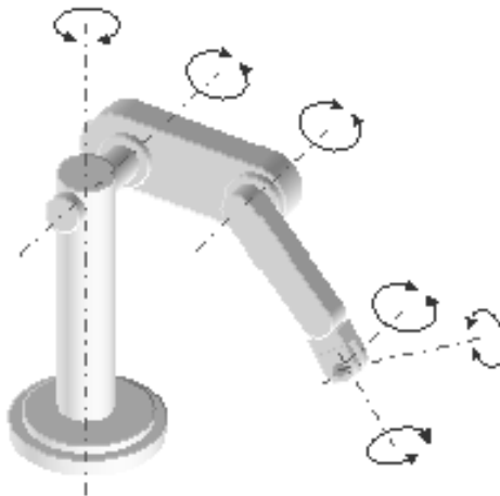
Figura 12. Grados de libertad de un brazo robótico
