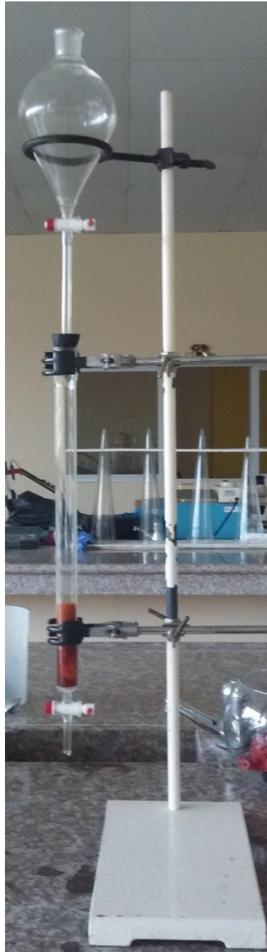
Figura 3-3 Tratamiento del agua por intercambio iónico con resina Purolite C 100 en el laboratorio.
