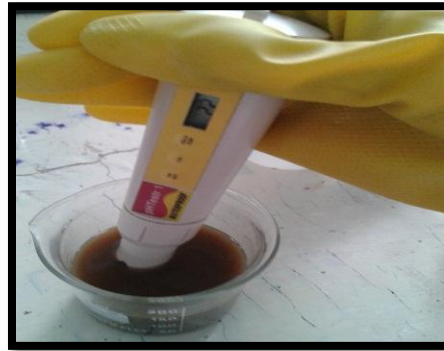
Acidificación: ácido sulfúrico-pH 2
