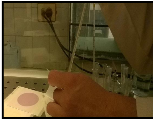
Figura 4-2: Distribución de la muestra en las placas Petrifilm E. coli Realizado por: Catagña, A; Noboa, D, 2015
