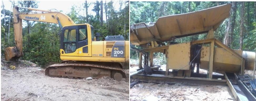
**Fotografía 9.** Excavadora Komatsu y Trommel
