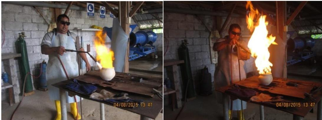
**Fotografía 32.** Proceso de fundición de oro
