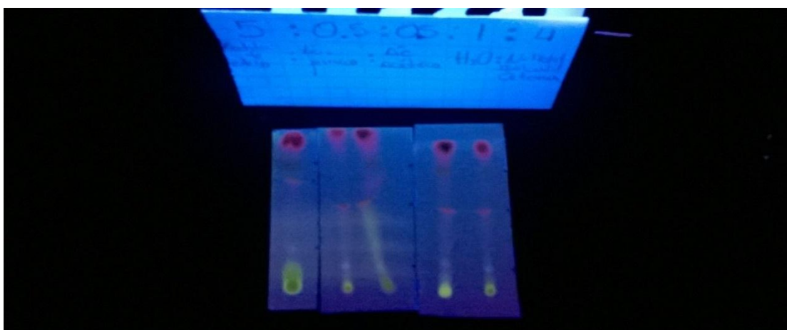
SISTEMA DE SOLVENTES Acetato de etilo, ácido fórmico, ácido acético, agua, metil isobutil cetona (6:0,5:0,5:1:4)
