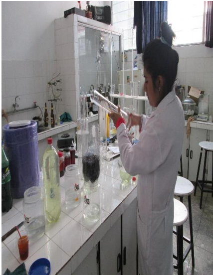
Filtro de carbón activado y grava
