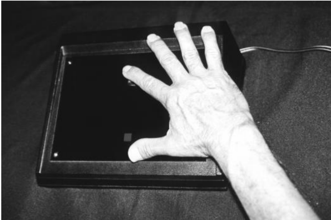
Equipo electrónico para medir tiempo de reacción simple. Fuente: (CASTILLO, 2014)
