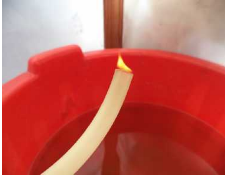
Fotografía 6-2: Prueba de flama Realizado por: Carlos Calderón 2015
