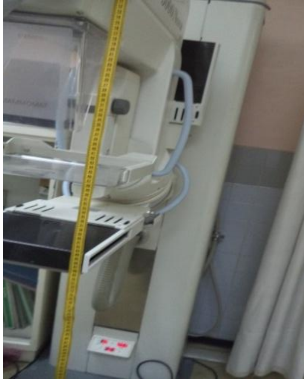
Figura 34-3 Medición de la distancia foco-imagen. Fuente: Jessica Fares
