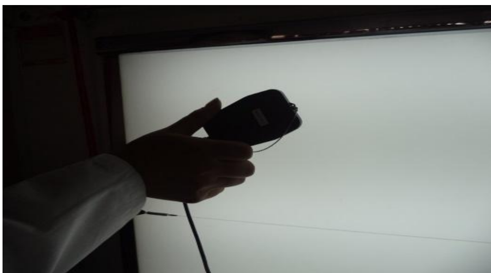
Figura 27-3 Medición de la luminancia de los negatoscopios usando el luxómetro. Fuente: Jessica Fares
