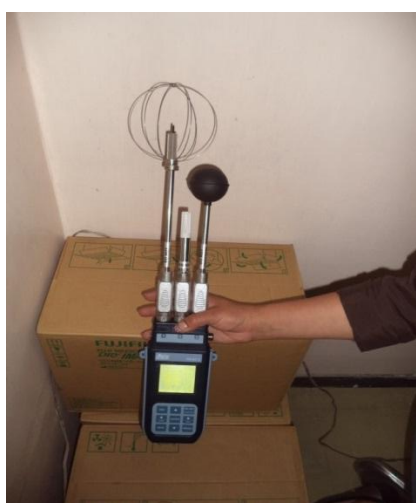
Figura 9-3 Medición de humedad en el almacenamiento de películas usando el HD32.3 – WBGT - PMV – PPD.
