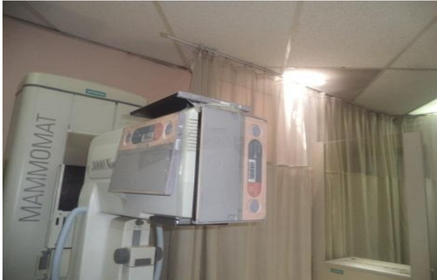
Figura 23-3 Comprobación de radiación de fuga usando chasis mamográficos. Fuente: Jessica Fares
