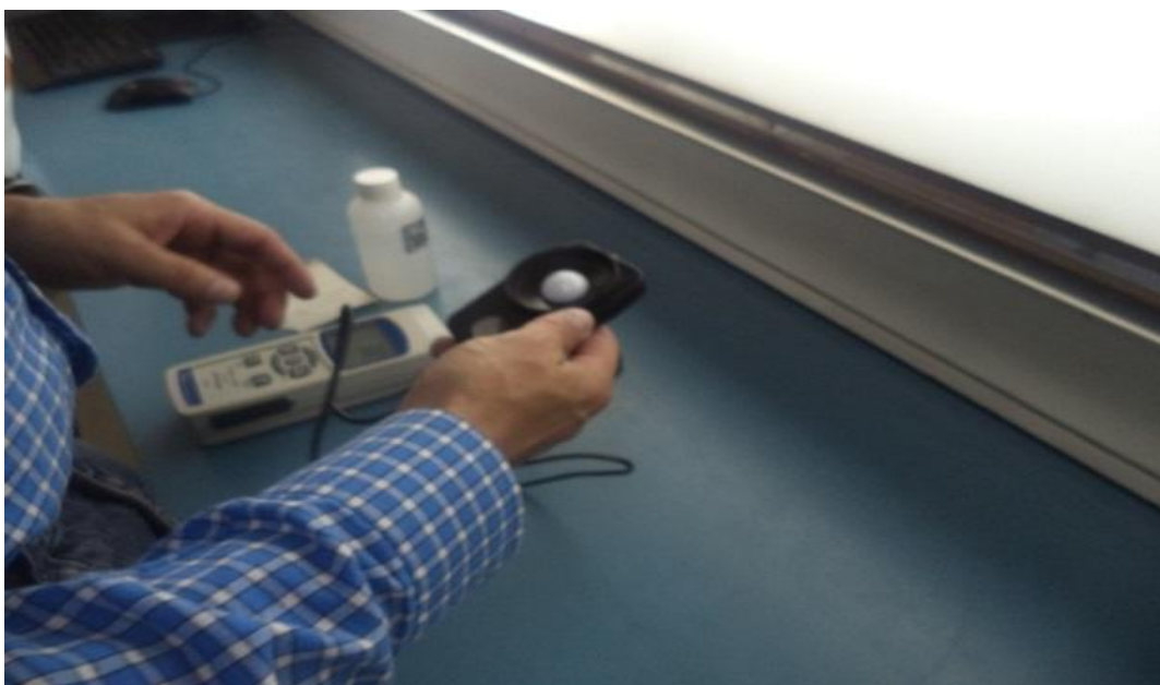
Figura 26-3 Medición de la sala de iluminación usando el luxómetro.
