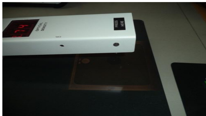
Figura 17-3 Medición de densidad óptica en el centro geométrico de la imagen.
