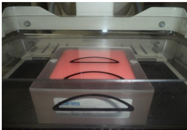
Figura 10-3 Comprobación del CAE para un espesor de 4,2 cm usando el fantoma de acreditación mamográfico modelo 156.
