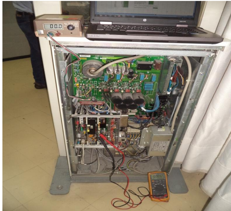
Figura 21-3 Medición de la tensión aplicada al tubo de rayos X. Fuente: Jessica Fares
