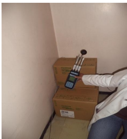
Figura 8-3 Medición de temperatura en el almacenamiento de películas usando el HD32.3 – WBGT - PMV – PPD.
