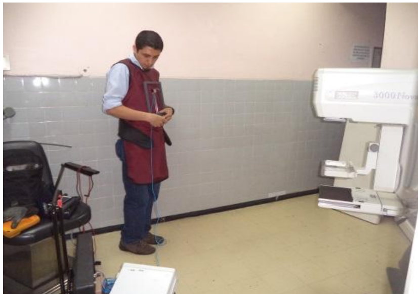
Figura 24-3 Medición de radiación de fuga usando una cámara de ionización y un detector semi conductor tipo T60005-001028. Fuente: Jessica Fares
