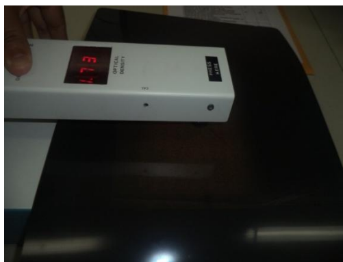
Figura 29-3 Medición de la densidad óptica por cada paso de selector de densidad usando el fantoma de acreditación mamográfico modelo 156 de 4,2 mm de espesor.
