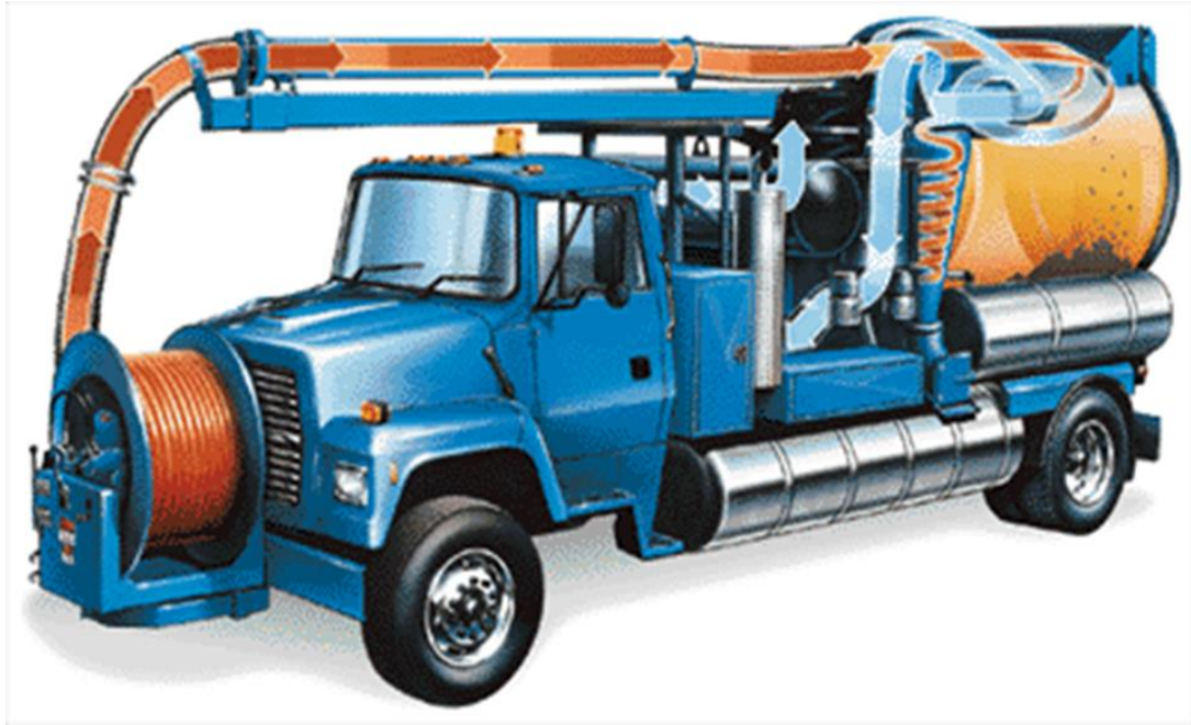
Figura 5-3 Principales componentes del camión hidrocleaner M-654 Fuente: VACTOR, 2010
