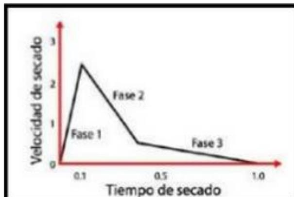
**Figura 5-1** Fases del Secado Primario.
