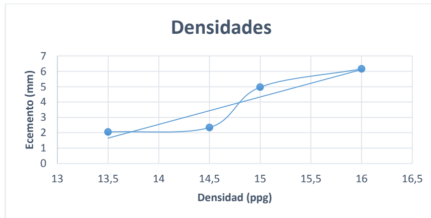
Figura 9-3 Gráfica de espesor de cemento a varias densidades Realizado por: Daniel Estrella, Mayo 2015
