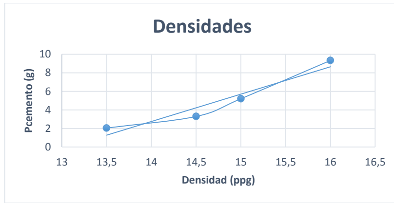
Figura 4-3 Grafica de peso de cemento con varias densidades Realizado por: Daniel Estrella, Mayo 2015
