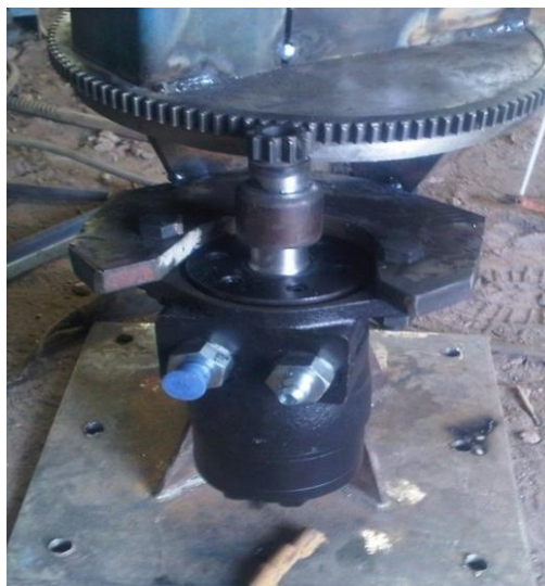
Figura 74. Montaje motor hidráulico
