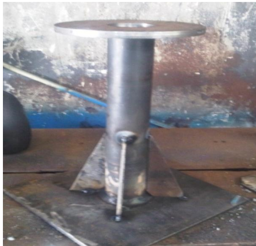
Figura 69. Soporte del brazo oleohidráulico
