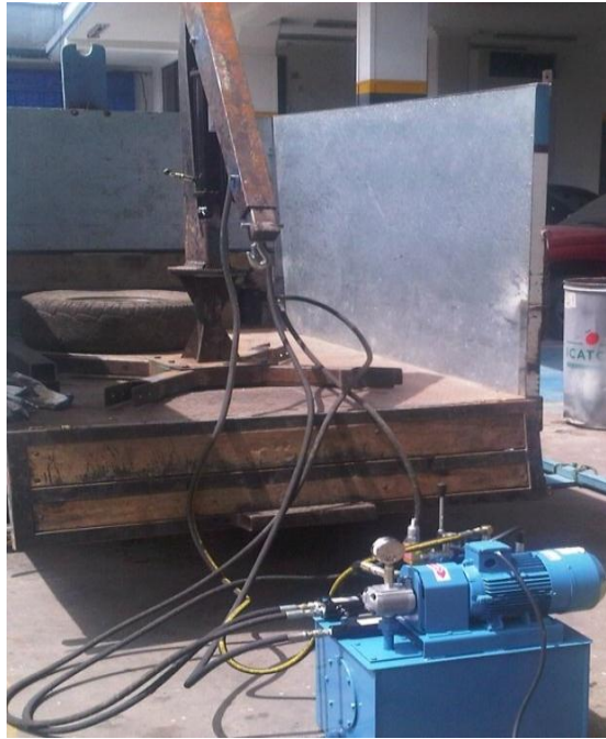
Figura 80. Brazo oleohidráulico armado
