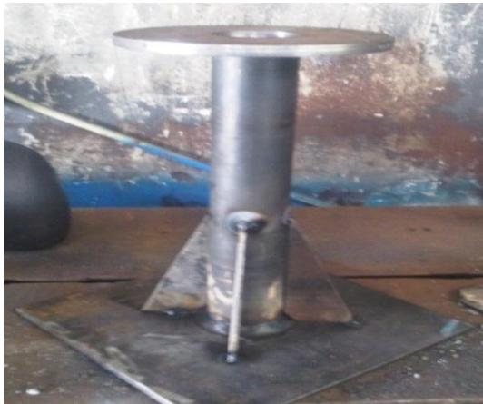
Figura 71. Montaje de la base giratoria
