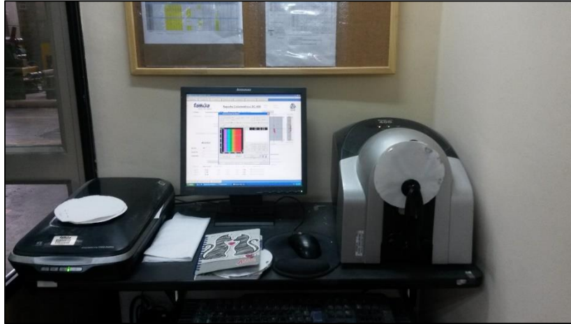
EQUIPOS UTILIZADOS PARA LA MEDICIÓN DE PUNTOS DE TINTA (SCANNER) Y MEDICIÓN DE BLANCURA (EXPECTRUN DATA COLOR)
