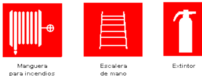
Figura 4 Señal indicadoras equipamiento contra incendios
