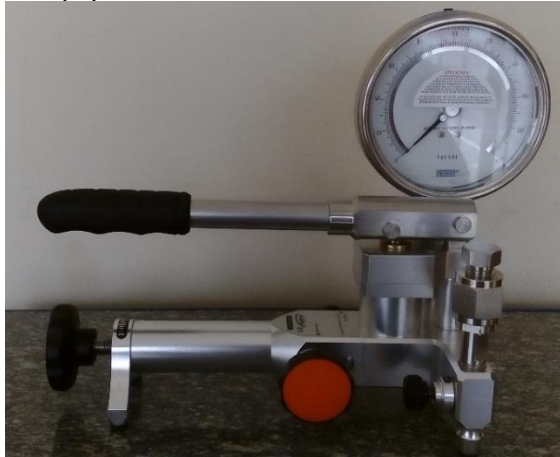
Figura 67. Equipo de calibración de manómetros neumáticos
