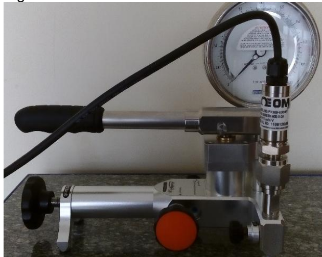
Figura 69. Calibración del sensor PX309-030GV
