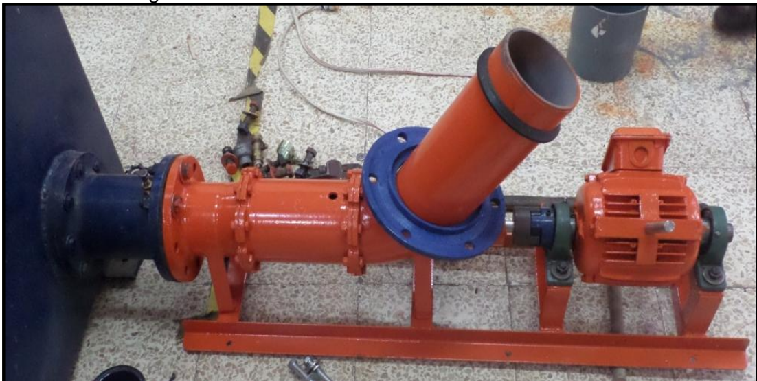
Figura 33. Estado actual de la bomba axial con el motor
