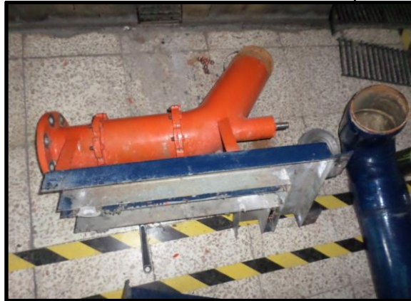
Figura 27. Empotramiento al suelo anterior del banco de pruebas de la bomba axial
