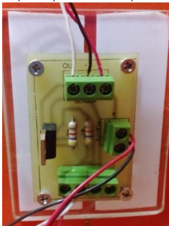
Figura 86. Placa para acoplamiento de señal para el sensor inductivo
