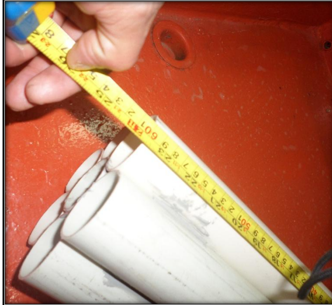
Figura 16. Longitud especificada del enderezador de vena líquida
