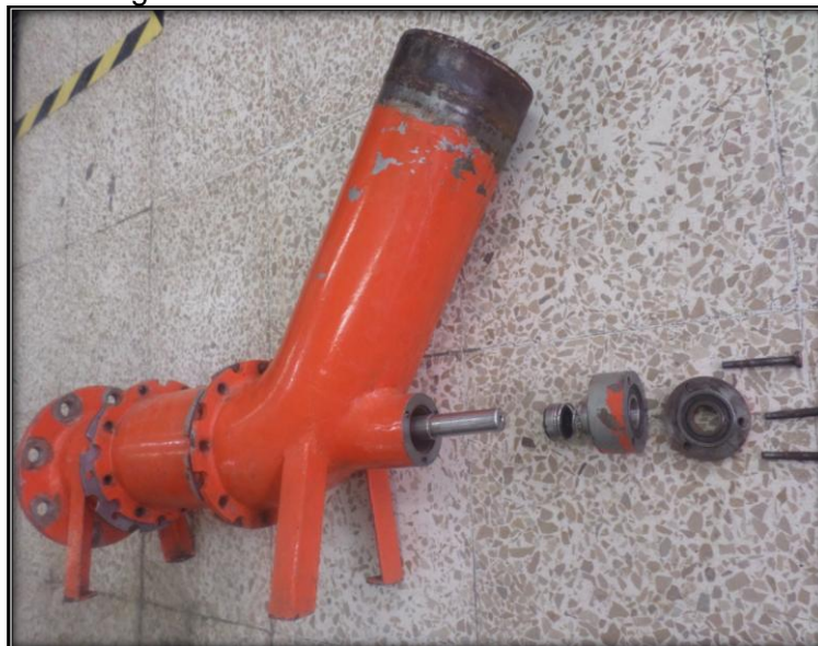
Figura 20. Estado anterior de la bomba axial
