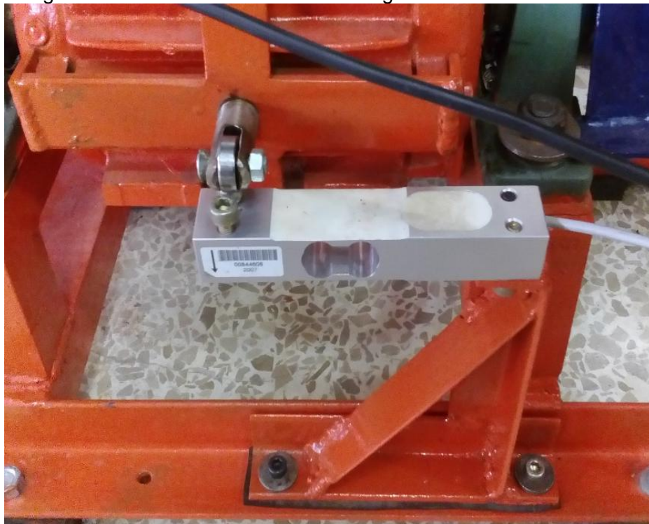
Figura 66. Ubicación de la celda de carga de flexión MODELO 102
