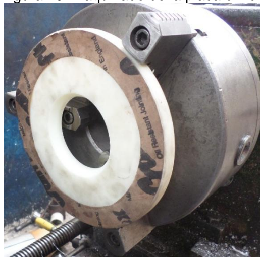
Figura 40. Maquinado de la placa orificio
