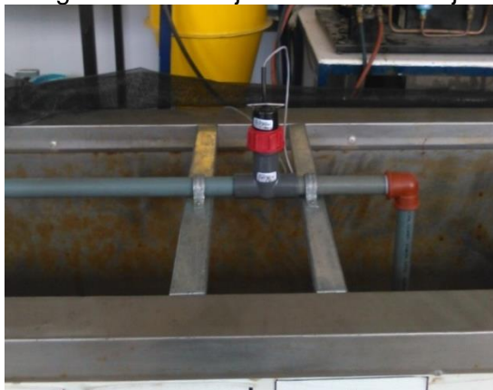
Figura 49. Montaje de sensor de flujo
