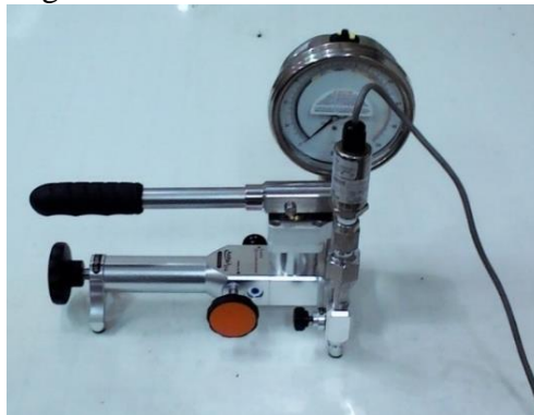
Figura 55. Calibrador de manómetros
