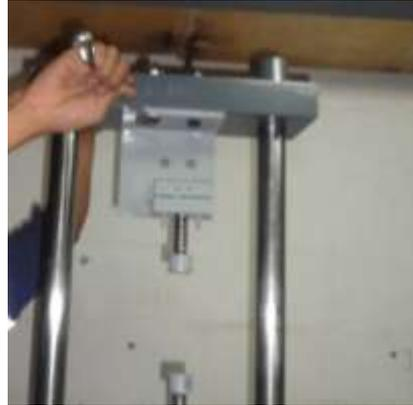
5. Colocar la polea y asegurarla ajustando los pernos.
