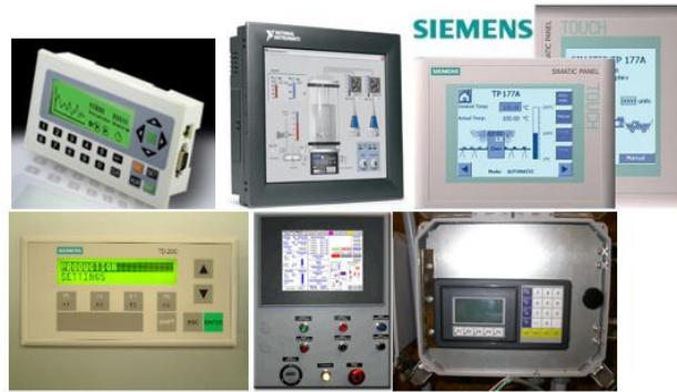
Figura 21. Terminales de operador
