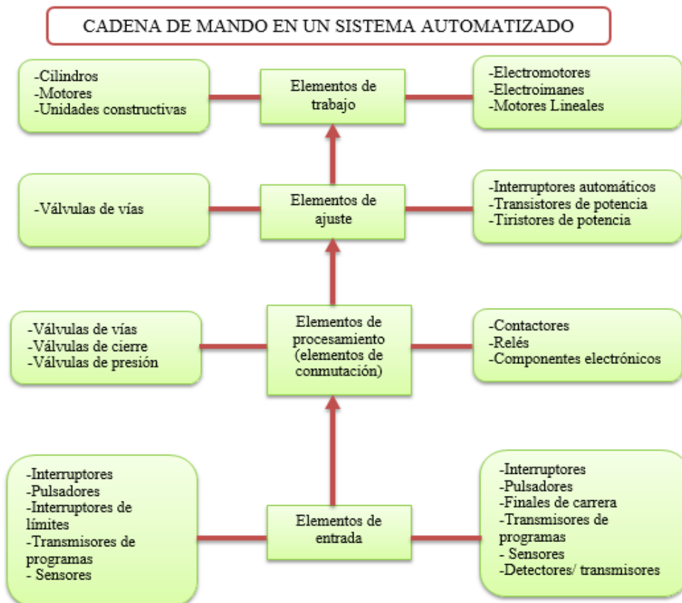
Figura 2. Cadena de mando en un sistema automatizado
