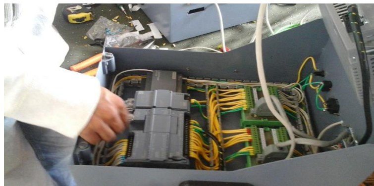
Figura 53. Cableado del PLC, CSM, LOGO
