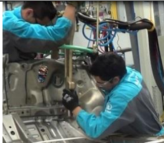
Figura 12-3: Proceso de soldadura con pistolas de punto
