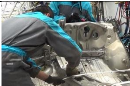
Figura 14-3: Colocación del soporte airbag
