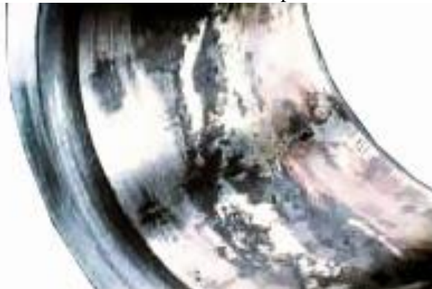
Figura 18. Decoloración del rodamiento por falta de lubricación.
