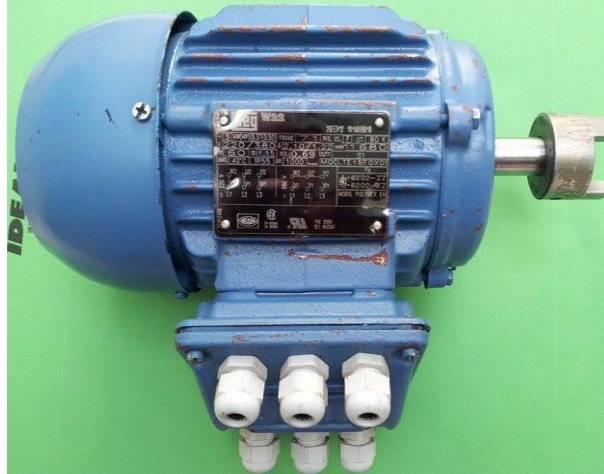
Figura 22. Motor eléctrico trifásico de 1/2 Hp.
