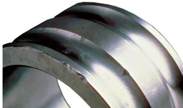
Figura 21. Daño por causa de un inadecuado montaje.
