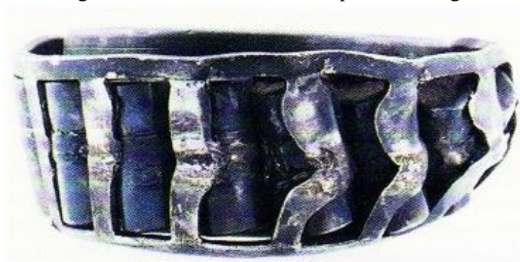
Figura 20. Rodamiento dañado por sobrecarga.
