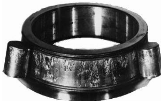
Figura 17. Rodamiento dañado por una inadecuada lubricación.
