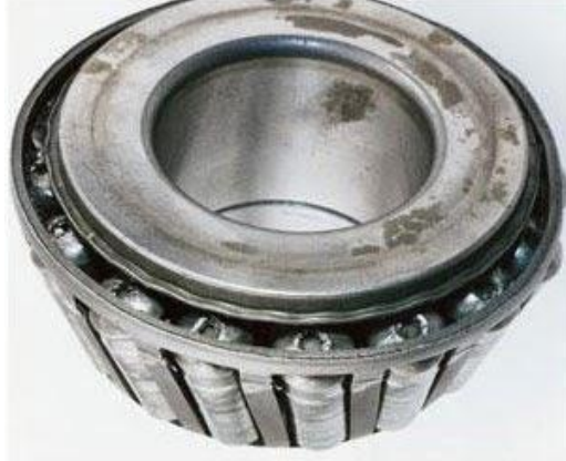
Figura 16. Rodamiento contaminado por partículas externas.
