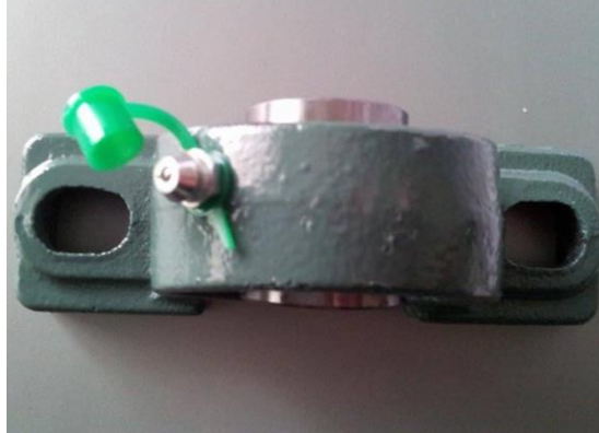
Figura 24. Punto de lubricación de chumacera.
