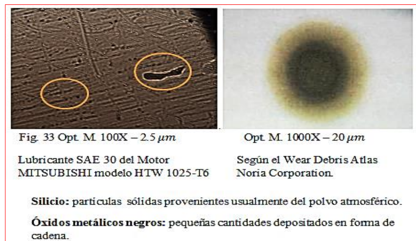
Figura 45. Ferrograma N° 1 de lubricante SAE 30, partículas de silicio y óxidos metálicos-MITSUBISHI
