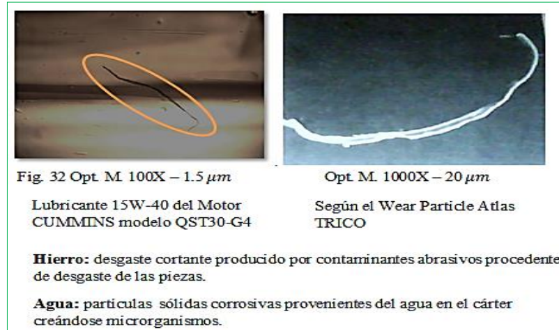
Figura 44. Ferrograma N° 4 de lubricante 15W-40, partículas de Fe y agua-CUMMINS
