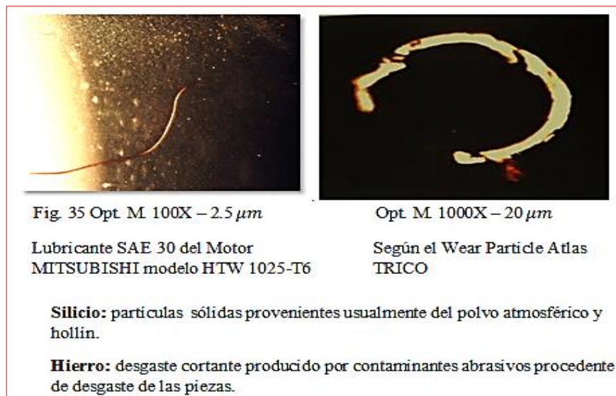
Figura 47. Ferrograma N° 3 de lubricante SAE 30, partículas de silicio y Fe-MITSUBISHI
