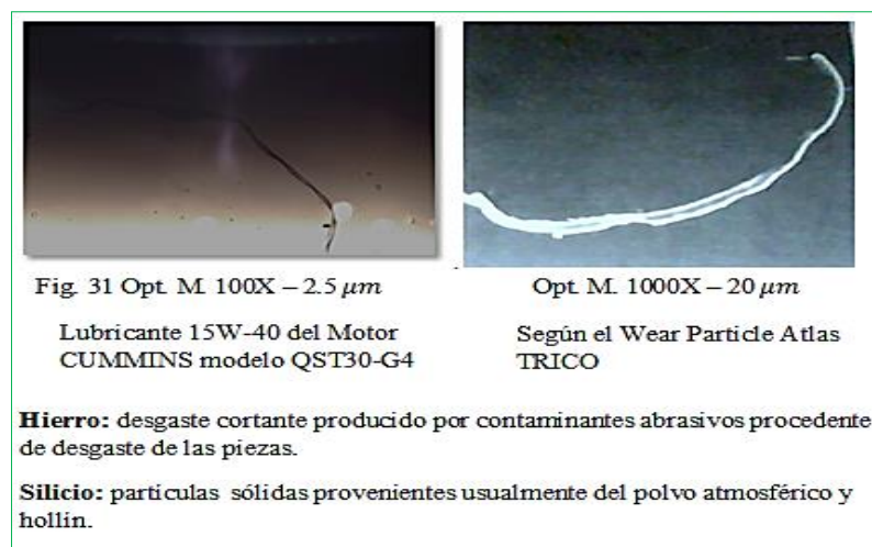
Figura 43. Ferrograma N° 3 de lubricante 15W-40, partículas de Fe y silicio-CUMMINS
