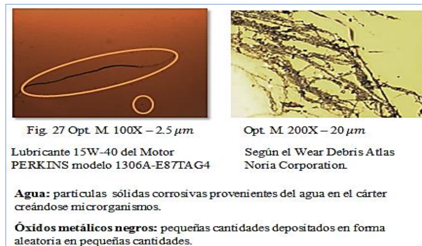
Figura 39. Ferrograma N° 3 de lubricante 15W-40, partículas de Agua y óxidos-PERKINS
