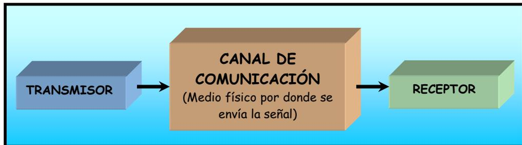
Figura 2.2. Elementos básicos y fundamentales del Sistema de Comunicación
