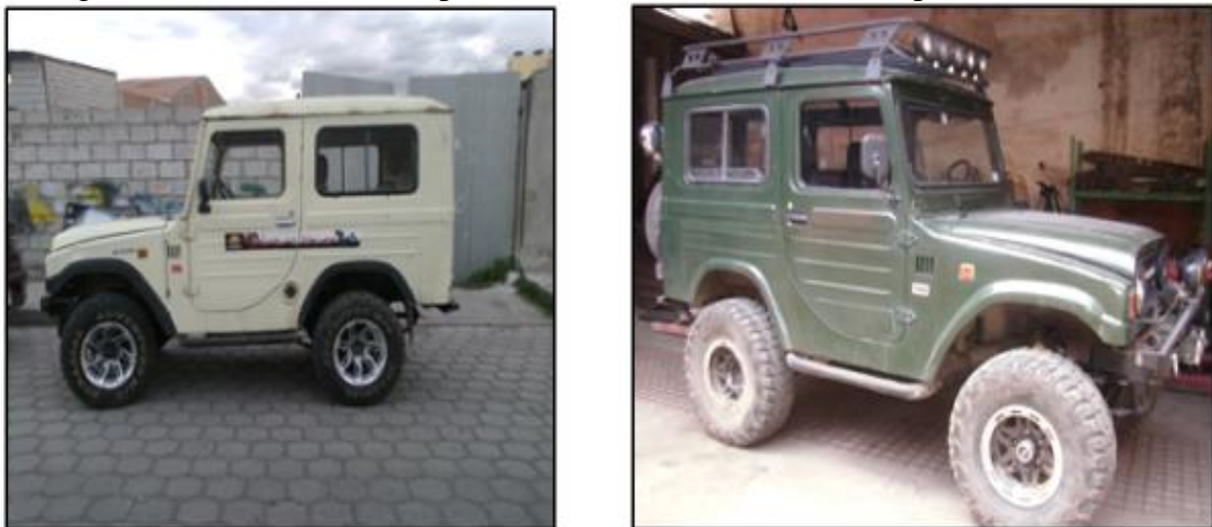
Figura 40. Vehículo con suspensión de serie, vehículo con suspensión levantada
