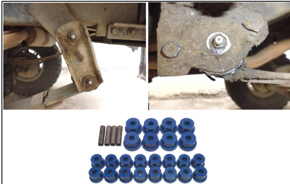
Figura 55. (a) apoyo móvil, (b) Apoyo fijo, (c) Bujes de nylon
