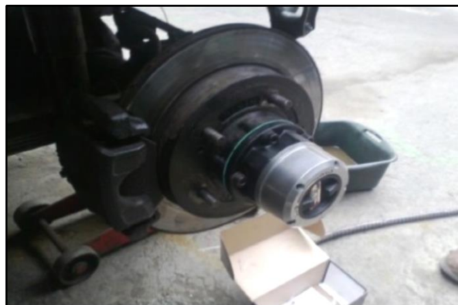
Figura 57. Discos de freno ventilados
