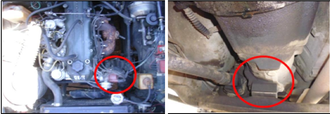
Figura 39. (a) Motor acoplado, (b) Bases de chasis para la caja de cambios
