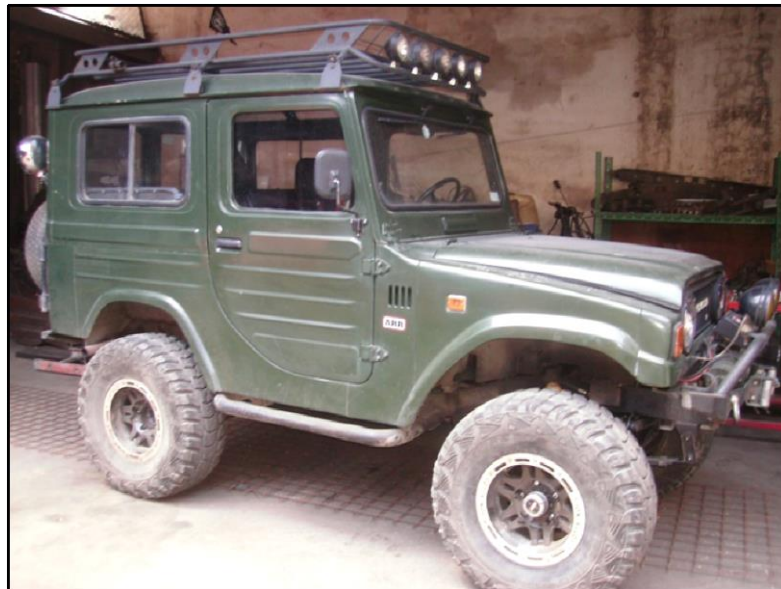
Figura 93. Suspensión delantera y posterior levantada
