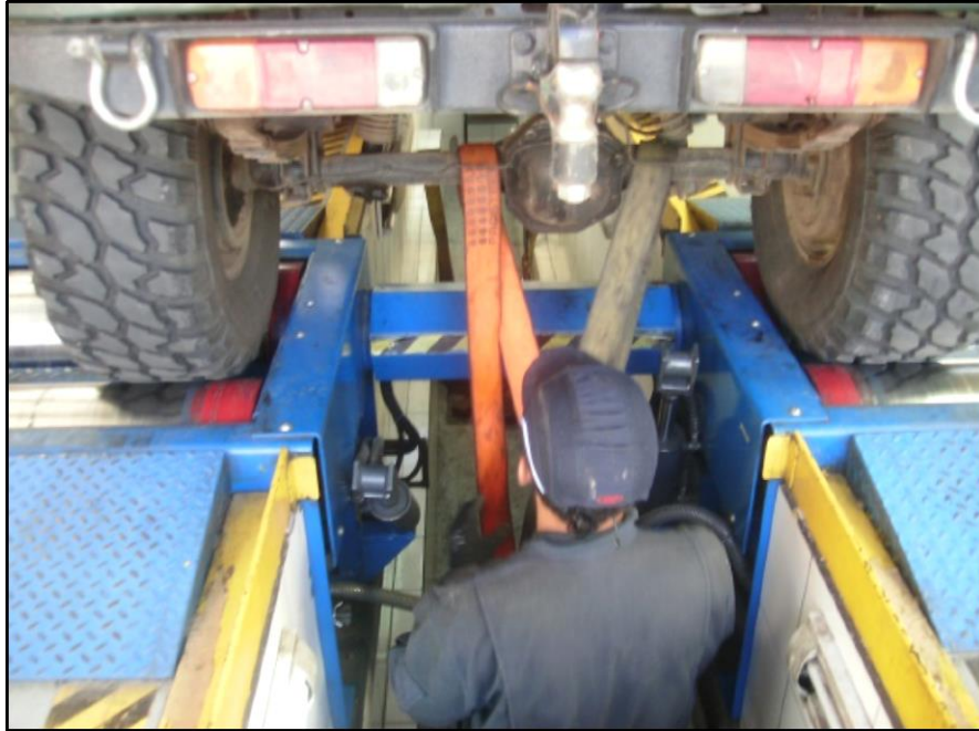
Figura 110. Sujeción del vehículo a los rodillos
