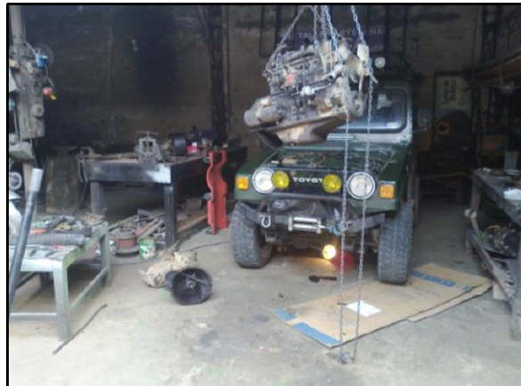
Figura 81. Desacoplamiento del motor original
