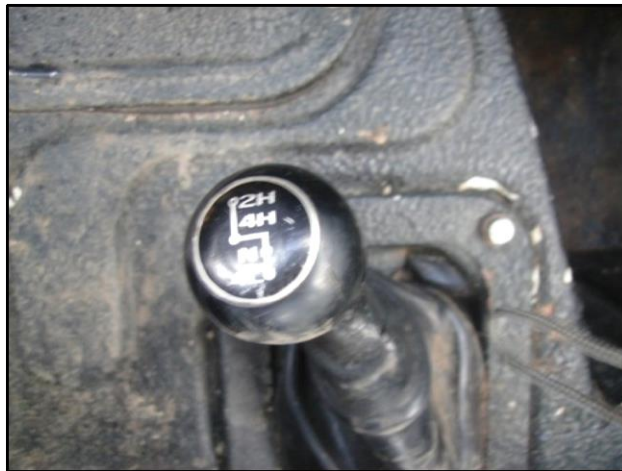
Figura 145. Palanca selectora de la caja de transferencia posición 2H
