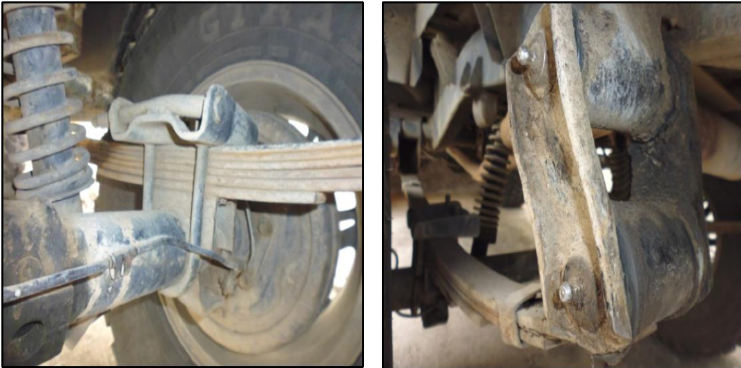
Figura 92. Cambio de posición de las bases de apoyo de la suspensión posterior
