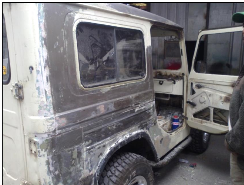
Figura 98. Colocación del removedor
