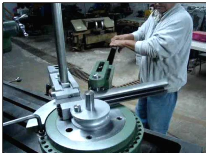
Figura 68. Doblado de los tubos
