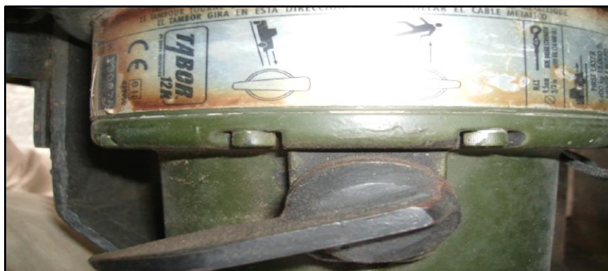
Figura 149. Palanca de bloqueo y desbloqueo del carrete
