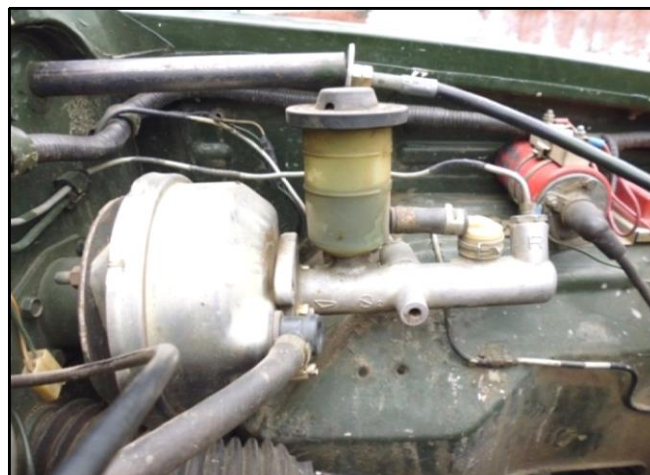
Figura 58. Cilindro principal de frenado con servo asistencia
