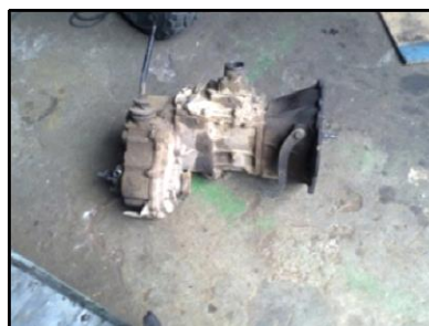
Figura 3. Caja de cambios y transferencia
