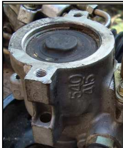
Gráfico 51. Cuerpo de la bomba hidráulica, fijación de ejes de sujeción
