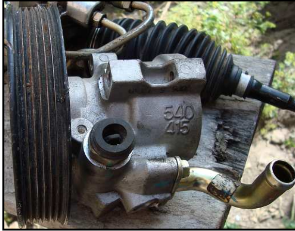
Gráfico 50. Cuerpo de la bomba desarmada, carcasa y ducto principal
