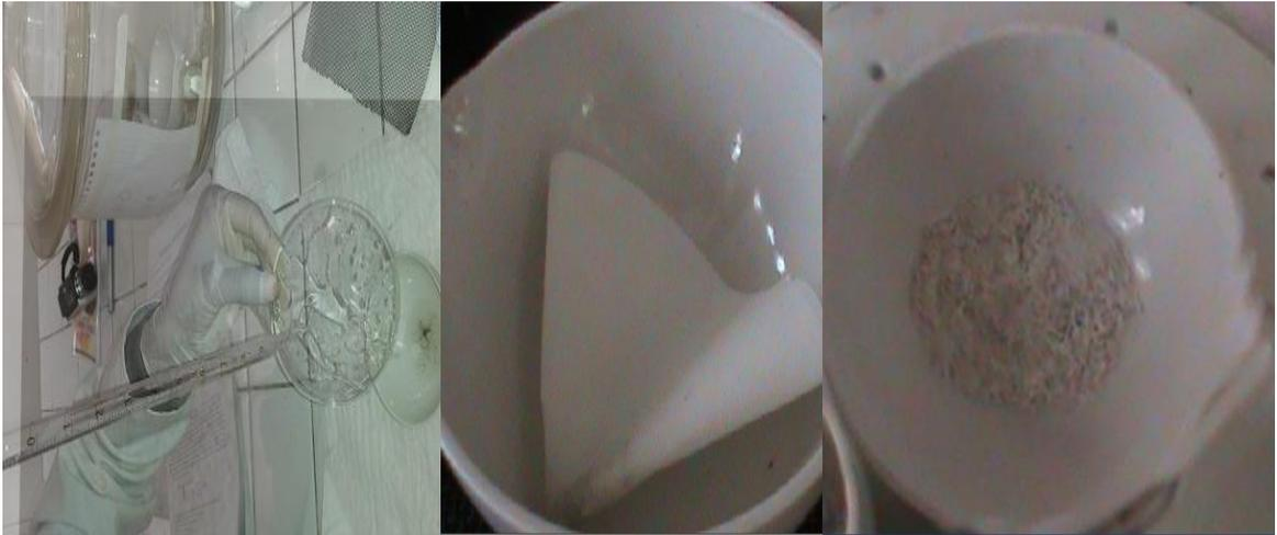
**Fotografía 34:** Determinación de cenizas insolubles en ácido clorhídrico
