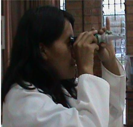
**Fotografía 38:** Determinación de Índice de refracción
