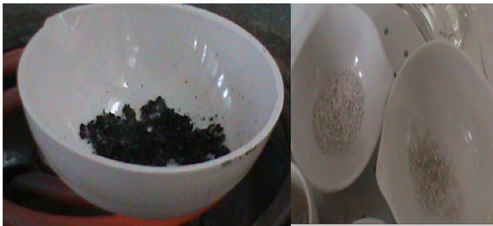
**Fotografía 32:** Determinación de cenizas totales
