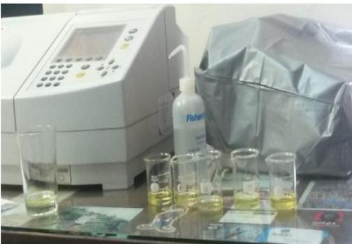
**Fotografía 44:** Reactivos para la reacción de la cuantificación de flavonoides
