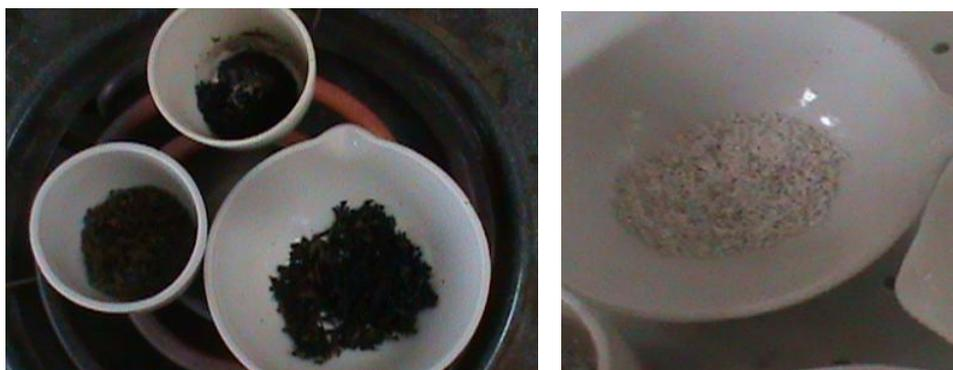
**Fotografía 33:** Determinación de cenizas solubles en agua
