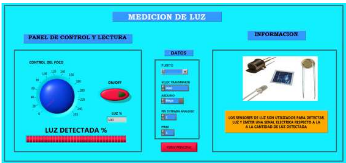
Ilustración 68. Panel frontal para medición de luz.
