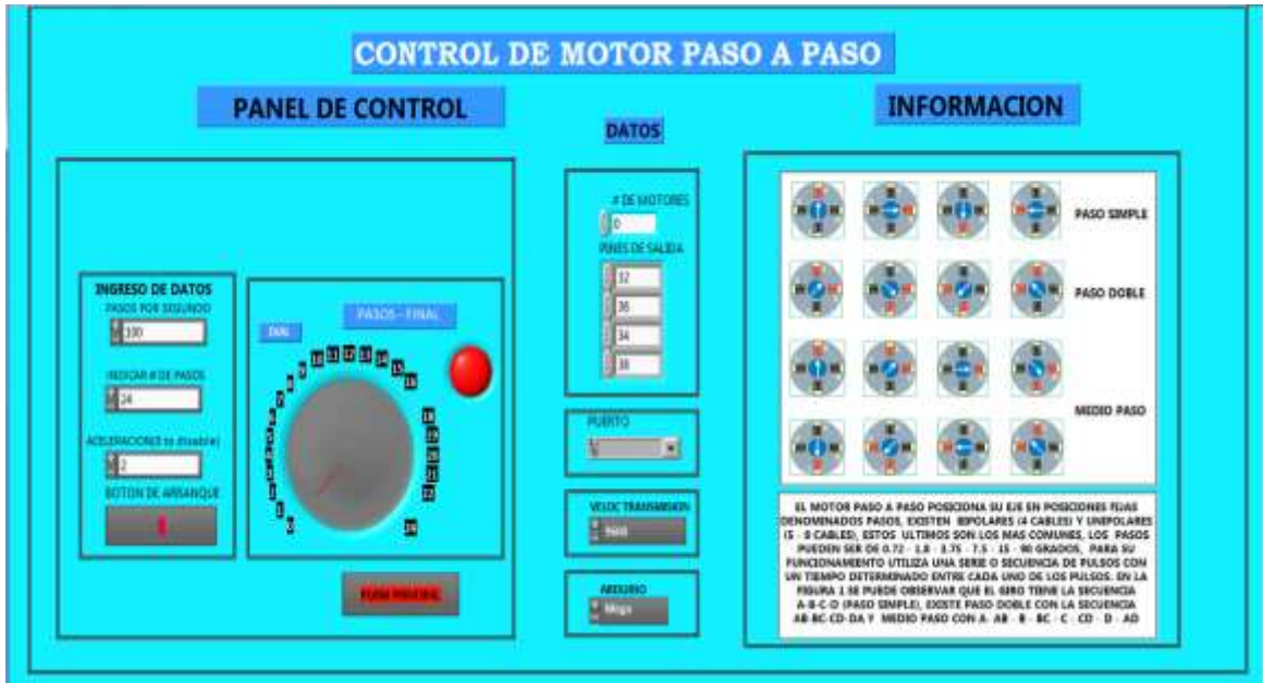
Ilustración 73. Panel de control motor paso a paso.
