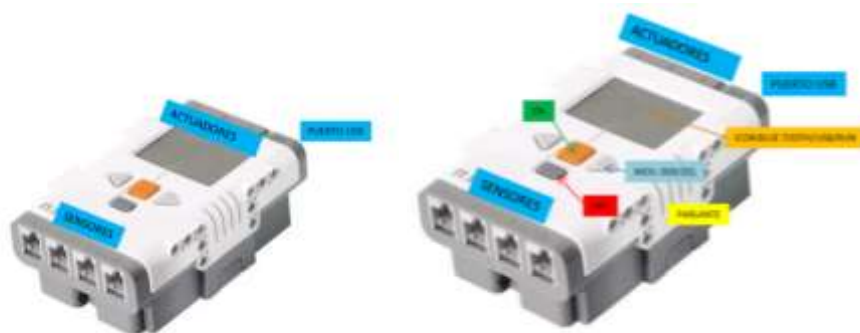
Ilustración 45. Módulo de Control
