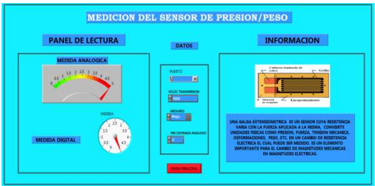
Ilustración 69. Panel frontal de lectura para sensor de presión.
