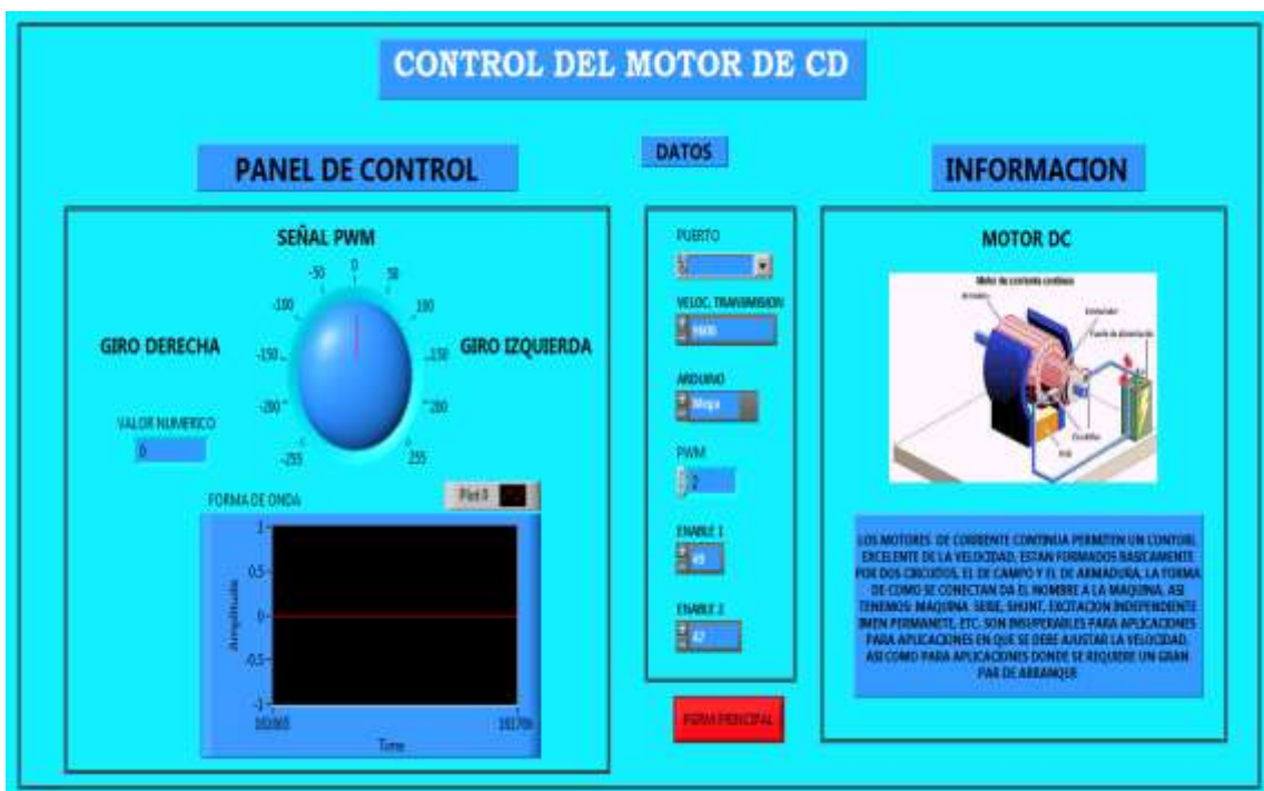
Ilustración 71. Panel de control del motor CD.
