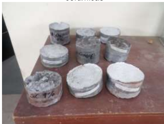
Figura 17. Fundiciones de ZA27 en molde de hierro fundido reforzado con partículas cerámicas
