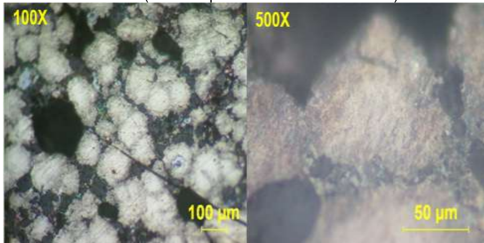
Figura 64. Microestructura de la Aleación ZA27 reforzada con 6% de partículas de Cuarzo (atacada químicamente con Palmerton)
