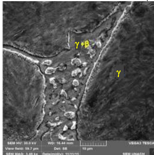
Figura 36. Microestructura de la aleación ZA 27 (SEM 3500X)
