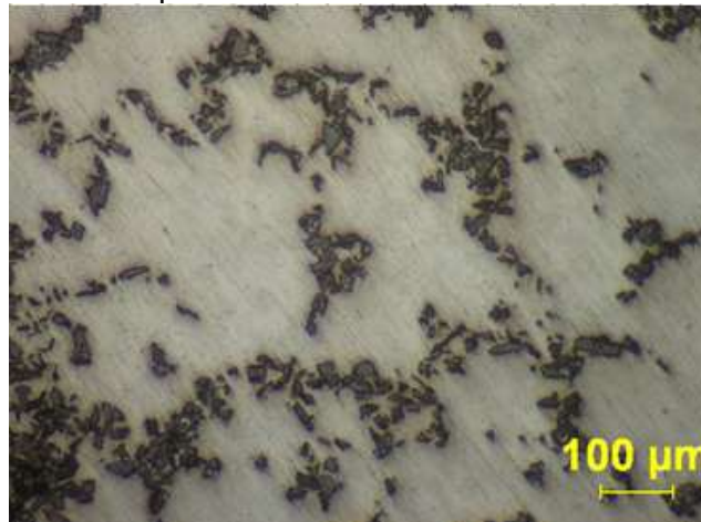
Figura 19. Microestructura a 100x de la aleación ZA 27 Reforzado con 6% de partículas de SiC de 25 \mu\text{m} .
