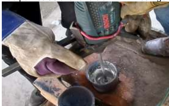
Figura 15. Adición de partículas a la fundición ZA 27 con generación de vórtice
