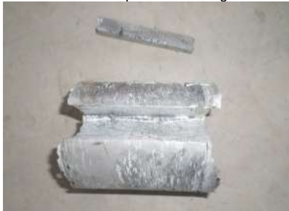
Figura 16. Fundición de ZA 27 con presencia de aglomeraciones y porosidad.
