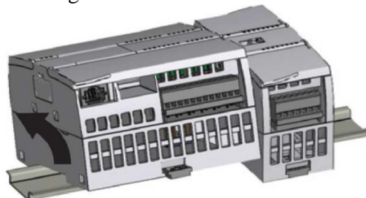
Figura 71. Extracción del PLC
