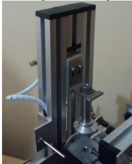
Figura 47. Montaje del sistema de prensado
