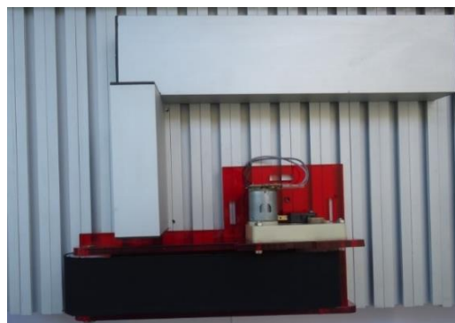
Figura 46. Montaje de la banda transportadora
