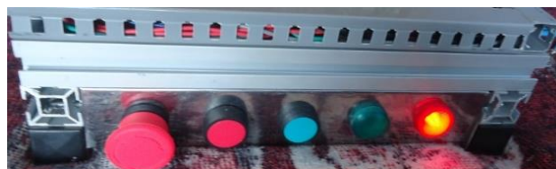
Figura 51. Montaje de botonera de inicio y paro
