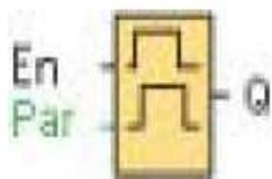
Con el generador aleatorio es conectada y desconectada nuevamente la salida dentro de un tiempo máximo establecido en los parámetros de conexión y desconexión.
