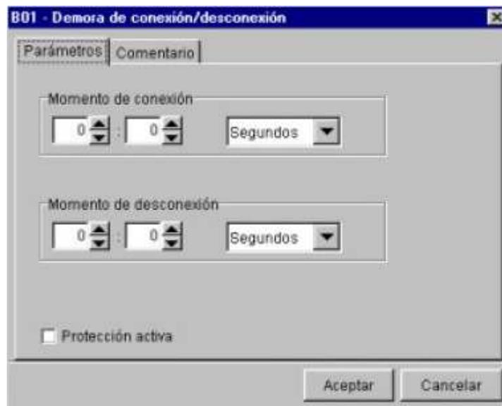
Figura 69 Parámetros de retardo a la conexión y desconexión.
